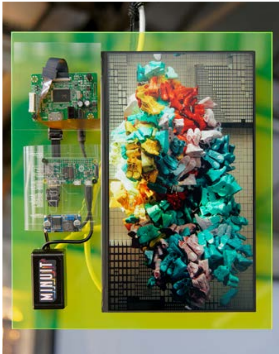
Dorian Rigal (Minuit), Le Tableau et L'écran #03 L'amour digital Lcd screen, Raspberry Pi Zero v1.3, 12V DC, Plexiglass 307x350x50mm, pièce unique
